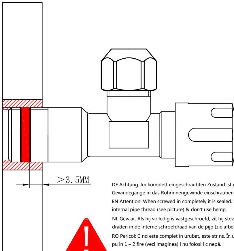
DE Achtung: Im komplett eingeschraubten Zustand ist es dicht. Die Dichtung Mindestens 1 – 2 Gewindegänge in das Rohrinnengewinde einschrauben (siehe Bild) & kein Hanf verwenden.
