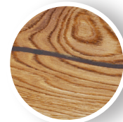
čelní a plošné trhliny
