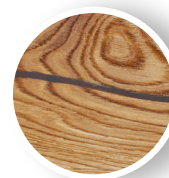
čelní a plošné trhliny
