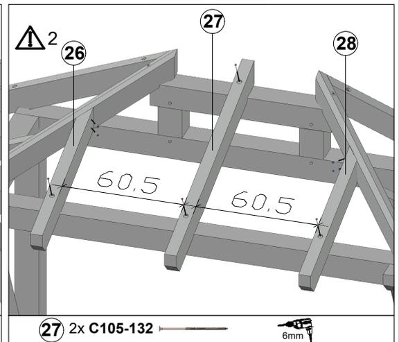
5. Dachschalung UH2/12 Roof boarding / Coffrage de toiture / Dakbeschot / Střešní prkna / Stropné dosky
