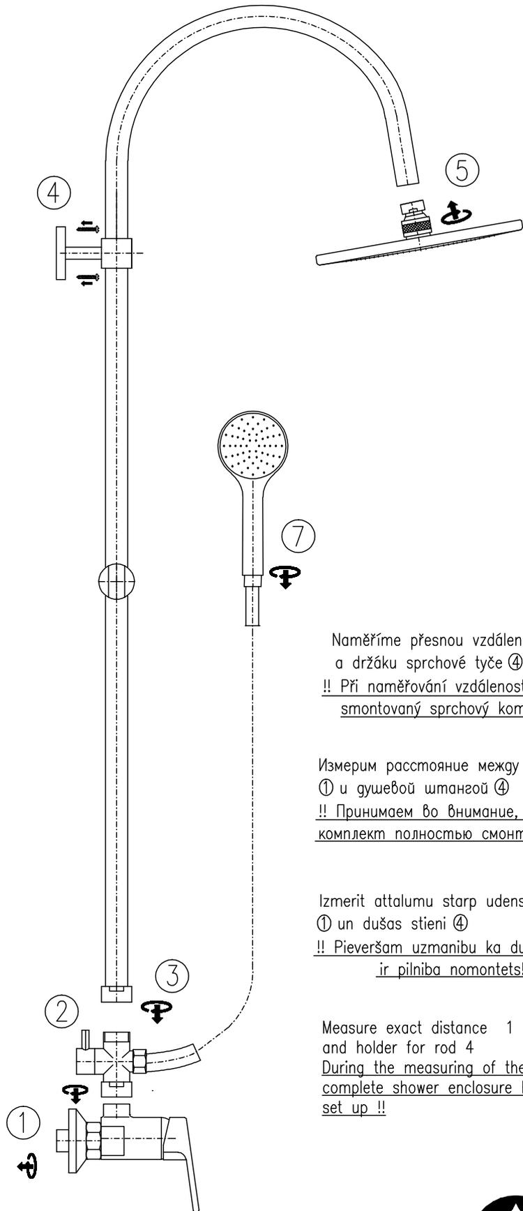
Naměříme přesnou vzdálenost ① baterie a držáku sprchové tyče ④
