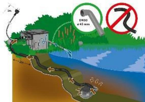
**Filtraci** umístěte k jezírku s výtokem vody nasměrovaným spět do jezírka, voda může téct z filtrace přímo do jezírka, nebo můžete filtr umístit i dále. Je pak zapotřebí na výtoku vody pomocí běžných instalatérských trubek udělat prodloužení za pomoci kolene a trubky DN 50 Ø 45 mm. Nepoužívejte hadici by došlu by ke zúžení, filtr by pak mohl přetékat. Dbejte na to, aby byla filtrace umístěna vodorovně.
