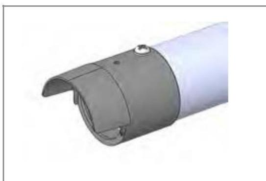
Když je konec trubky svislý, musí být dodaný ventilační kryt spolu s víkem potrubí, aby se zajistilo, že déšť a sníh nevniknou do potrubí. Víko trubky a ventilační kryt jsou montovány společně se dvěma dodanými šrouby, jak je znázorněno níže.
