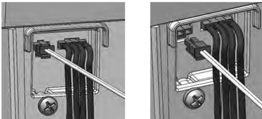
Toaleta musí být připojena ke zdroji napájení. Toaleta je vybavena napájecím adaptérem pro 110-240 V a 12 V kabelem baterie. Bez ohledu na zdroj energie musí být kabel připojen k zadní části toalety na vyznačeném vstupu na obrázku výše. Zkontrolujte, zda je zástrčka správně připojena.
