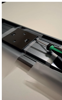
2. Pomocí šroubováku opatrně uvolněte úchyty lišty
