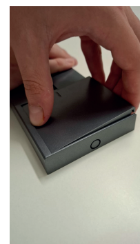
6. Přichyťte si lištu a druhou rukou vložte prsty mezi vypínač ON/OFF na liště. Palec přiložte na druhou stranu od prstů. Poté přiměřenou silou vyjměte kryt vypínače ON/OFF.
