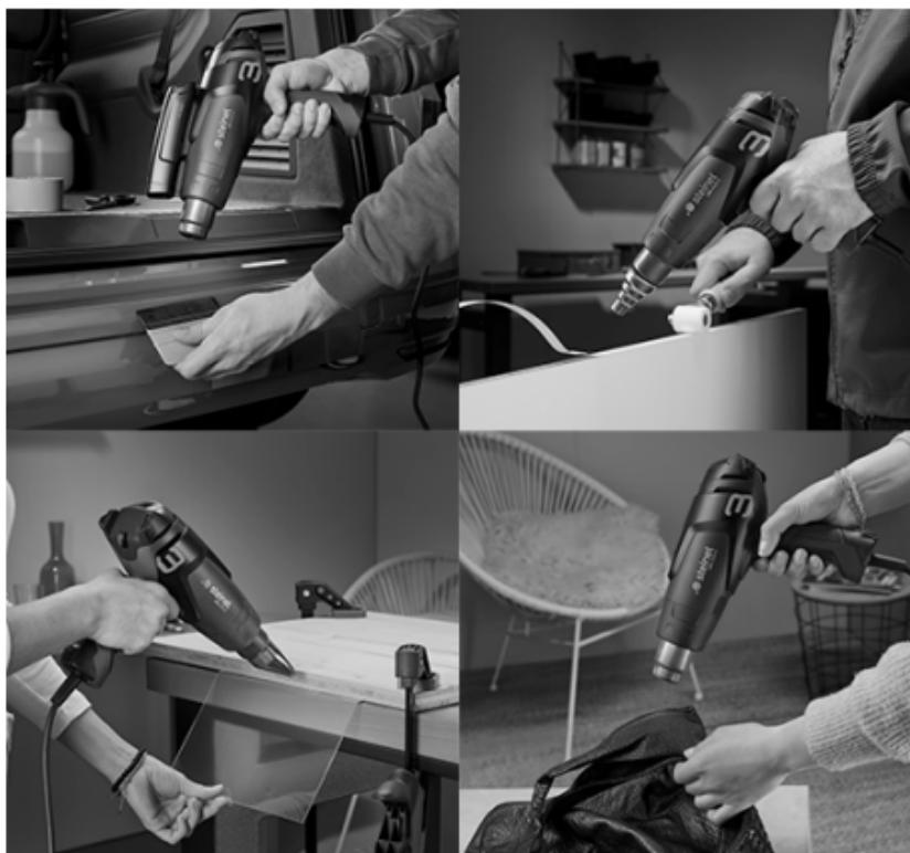
**Verf verwijderen:** de verf wordt zacht gemaakt en kan met spatel en krabber worden verwijderd.
