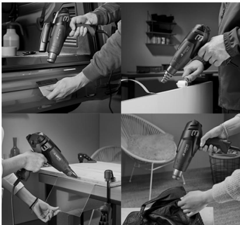
**Rimozione della vernice:** la vernice viene ammorbidente e può poi venire rimossa completamente con spatola e raschietto.
