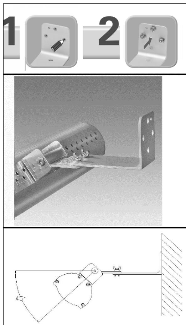
minst 1,8 meter. Avståndet mellan värmarens översida och tak o.s.v. måste vara minst en 0,3 meter men om taket eller innertaket består av brännbart material (t.ex. trä, gips, segelduk) måste det vara minst 1 meter mellan värmaren och 2 meter om värmaren riktas uppåt. På sidorna av apparaten måste det finnas ett utrymme av minst 0,5 meter från t.ex. väggar o.s.v.. Om du hänger upp värmaren utomhus ska du även se till att den inte hänger direkt i stark vind.
