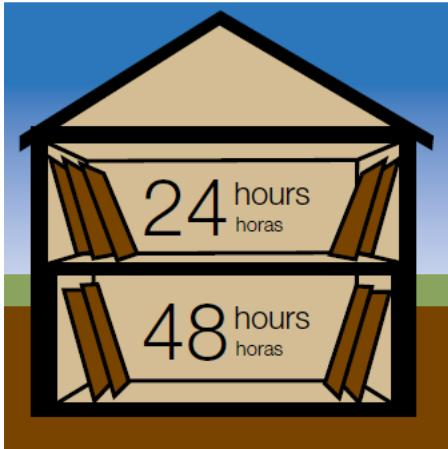
Před započetím prací umístěte panely ABITIBI nebo ABITIBI Plus do místnosti, ve které budou následně instalovány. Do prostorů s normální vlhkostí doporučujeme umístit panely 24 hodin před započetím práce. V místnostech s větší vlhkostí, v suterénech nebo nevytápěných místnostech, je třeba panely ponechat 48 hodin před samotnou instalací. Panely rozestavte podél stěn tak, aby obě strany byly volně přístupné vzduchu.
