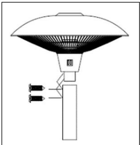
**Krok 7:** Zkontrolujte, zda je teleskopická trubka maximálně vysunutá. Zajistěte teleskopickou trubku v této maximální pozici utažením černé převlečné matic.
