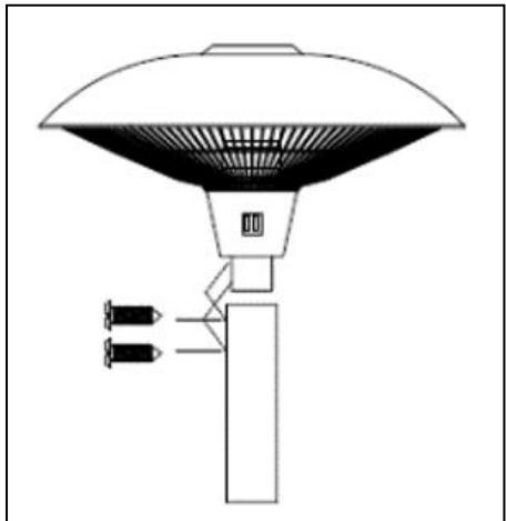
**Steg 7:** Kontrollera att teleskopröret är helt utdraget. Fäst teleskopröret i det maximalt utdragna läget genom att vrida åt justeringsringen.
