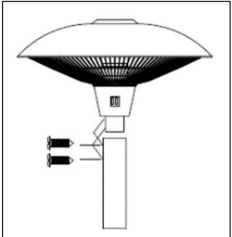
**Krok 7:** Skontrolujte, či je teleskopická trubica úplne vysunutá. Zaistite teleskopickú trubicu v tejto maximálnej polohe utiahnutím čiernej spojovacej matice. Opatrne vytiahnite napájací kábel zo základne. Zaistite napájací kábel pod zaťaženou základňou pomocou 4 dodávaných matíc M4. Nenapínajte napájací kábel v trubiciach. Ponechajte dostatočný priestor pre napájací kábel, aby bol spotrebič v najvyššej polohe, ale vyvarujte sa nadmernému napájaciemu káblu v trubiciach.
