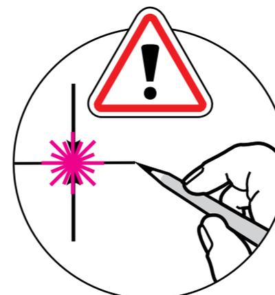
Při vzdálenosti zdí A a B 10 m by vzdálenost bodů 1 a 3 neměla být větší než 2 mm.
