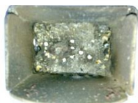
Příklad zaneseného spalovacího koše
