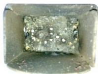
Příklad zaneseného spalovacího koše
