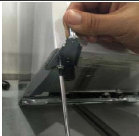
Montáž závěsu a stojanu na levé straně
