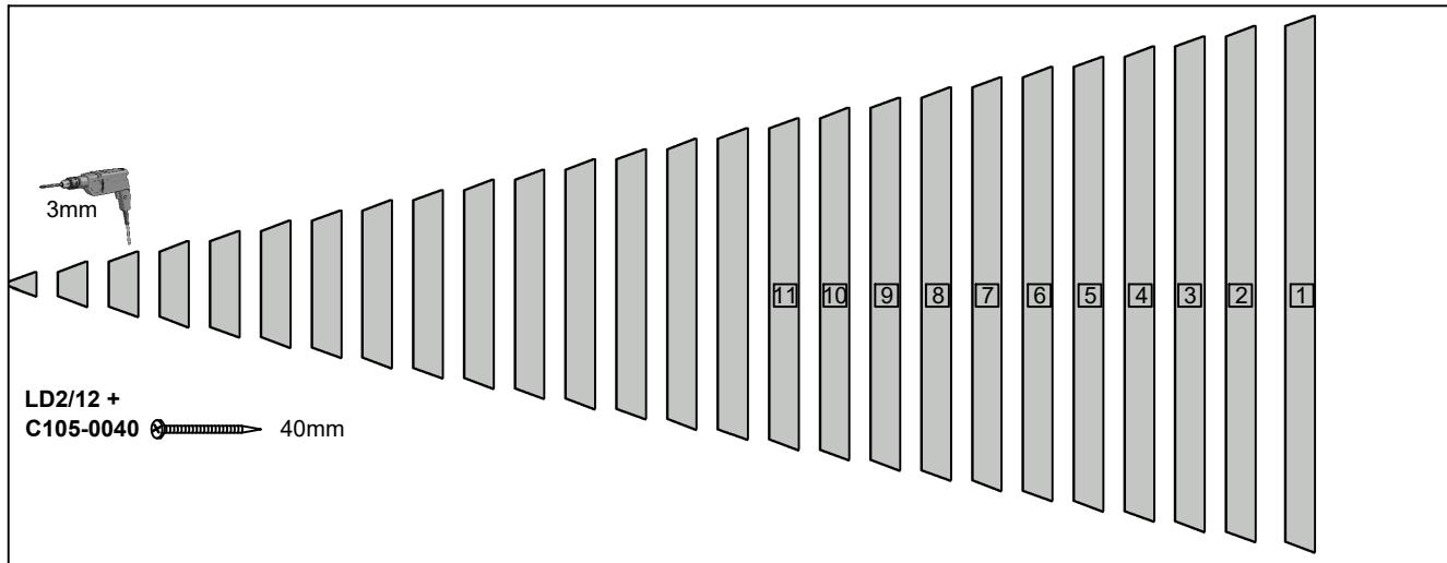
Die Dachbretter werden mit je zwei Schrauben pro Sparren verschraubt.
