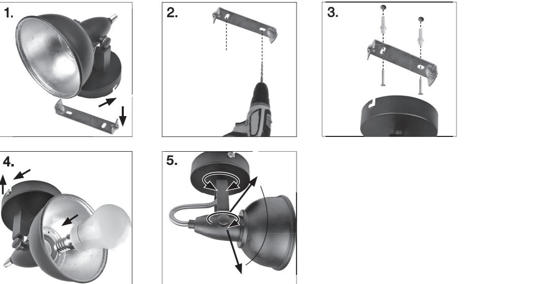
1. Odskrutkujte upevňovacie skrutky a odstráňte stropnú montážnu konzolu.
