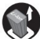
Akumulátor během přerušení práce, přepravy, skladování, údržby nebo opravy vždy vyjměte.
