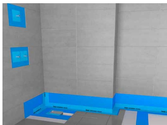
Doporučený rozsah provedení hydroizolačních nátěrů a těsnících pásků Hydroflex, v prostorách se zvýšenou vlhkostí.
