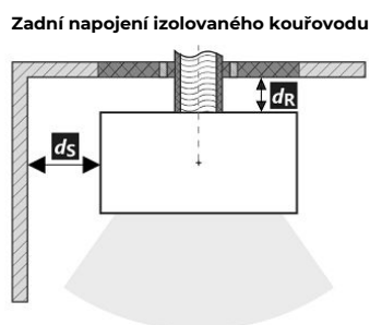
Prostup kouřovodu stěnou z hořlavé hmoty ČSN 06 1008
